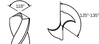
Web Thinned Point Pointe en réseau affiné Spitze mit Kegelmantelanschiff Punta con alma esmerilada Вершина с подточкой перемычки
