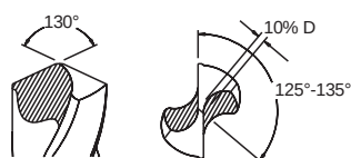
UX Point Pointe UX UX-Spitze Punta UX Вершина UX
